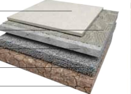
Indicata per applicazioni carrabili o sottoposte a sollecitazioni eccezionali. Incollare **due2** su massetto cementizio. Lasciare fuga da 2 mm almeno e rispettare i giunti di dilatazione.
