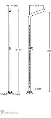
IT Colonna doccia da esterno/interno a pavimento con miscelazione progressiva, sistema di fissaggio e alimentazione a terra, e sistema di svuotamento acqua entroterra.
