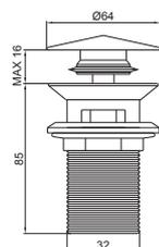
**Донный клапан**Донный клапан нажимного типа,
