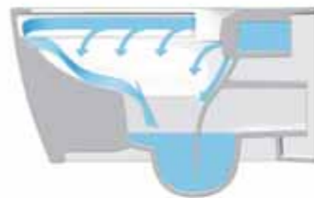
Einwandfreie Bepflung der Innenfläche. Perfect flushing of the inner surface. Lavado perfecto en el interior de la taza.
