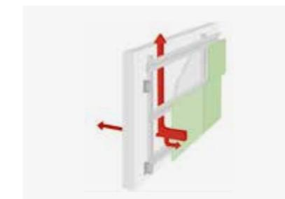
**En verano** el sol incide directamente sobre el aplacado y no sobre el edificio, calienta el aire de la cámara, disminuye su densidad y por convección asciende, ocupando su lugar aire fresco. Este es el fenómeno denominado "efecto chimenea", que evita la acumulación de calor en la fachada. El aislante térmico proporciona una protección adicional contra los agentes atmosféricos.
