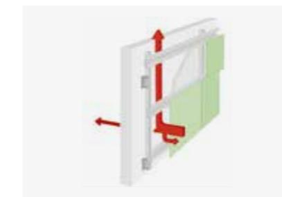
**En invierno** entran en juego otros factores, ya que la radiación solar no es suficiente para conseguir estos movimientos de aire. En este caso la fachada actúa como acumulador de calor, ayudando la cámara de aire a la estabilidad térmica del sistema. El aislante térmico proporciona una máxima acumulación térmica de los componentes interiores que impide la pérdida de calor en el interior del edificio.
