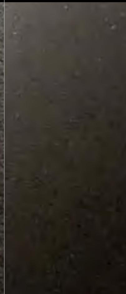
Superficie naturale: il materiale risulta opaco ed omogeneo; la superficie non subisce ulteriori lavorazioni dopo la cottura.
