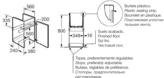
Al lavadero se le puede adaptar un mueble (ver fotografía) cuyo esquema de montaje acompañamos para aquellas personas interesadas en su construcción.
