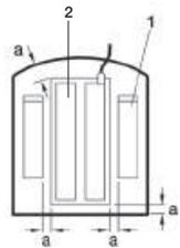
**Installation:** La plaque chauffante (2) est placée dans la partie arrière du miroir, en laissant une distance minimale de 50 mm du bord ou des supports métalliques (1) de fixation du miroir au mur. a = 50 mm.
