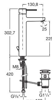
**5A3460C00** Mezclador de caño alto para lavabo con desague automático y enlaces alimentación flexibles.
