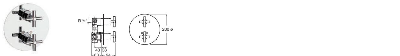
**5A0643C00** Mezclador termostático empotrable de 1/2" - 1/2" para baño o ducha (25 l/min) con desviador-regulador de caudal a las dos salidas superiores. Libre salida baño.
