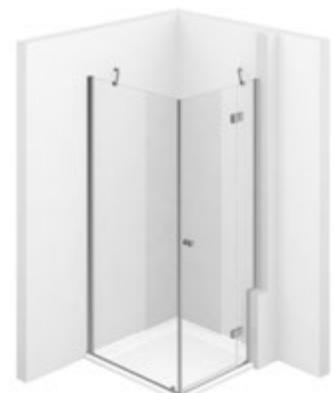
La présence de saillies dans le mur doit être résolue au cas par cas, selon les dimensions spéciales détectées. Le verre doit être profilé et bordé par un petit profil pour une finition impeccable.
