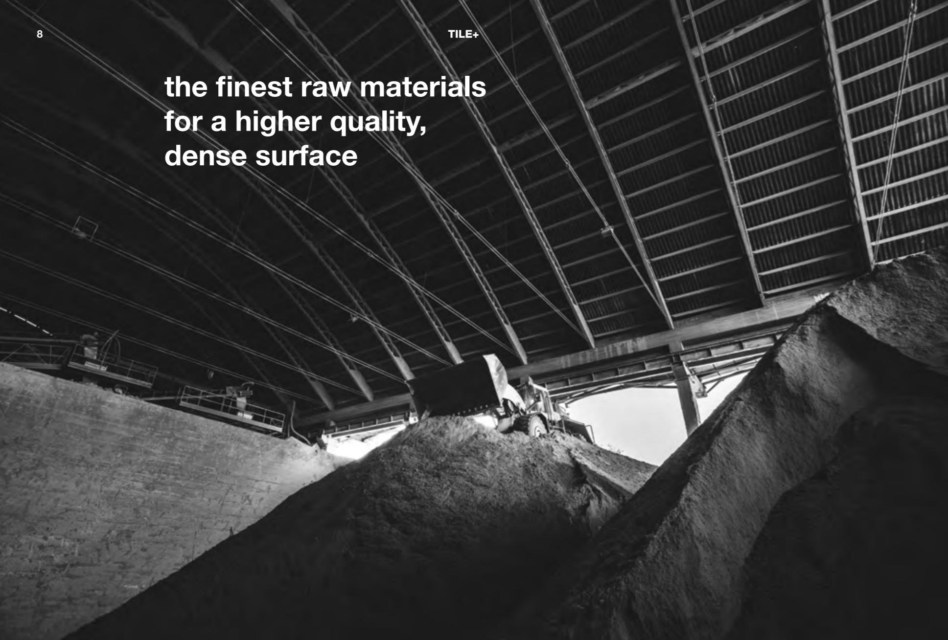
La qualità inizia con la **selezione delle migliori materie prime**, una composizione di sabbie, argille e altri materiali naturali che vengono sottoposti a un processo di pressatura e cottura ad una temperatura che supera i 1200°. La sinterizzazione trasforma la materia in un **corpo solido dalle caratteristiche insuperabili**, una lastra di gres porcellanato resistente, versatile e autentica.
